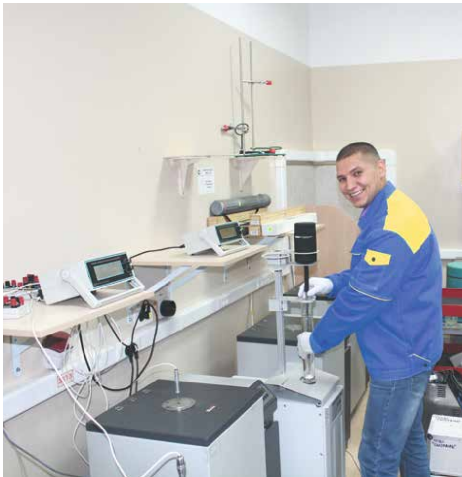
Осуществление поверки эталонных термометров сопротивления с использованием вторичного эталона температуры
