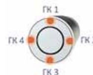
Рис. 3. Расположение датчиков гамма-каротажа в корпусе винтового забойного двигателя
