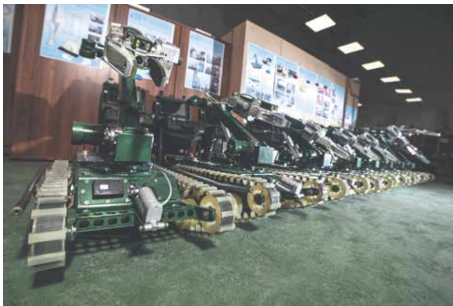
Мобильный робототехнический комплекс МРК-15 (принят на снабжение Федеральной службы войск национальной гвардии Российской Федерации)
